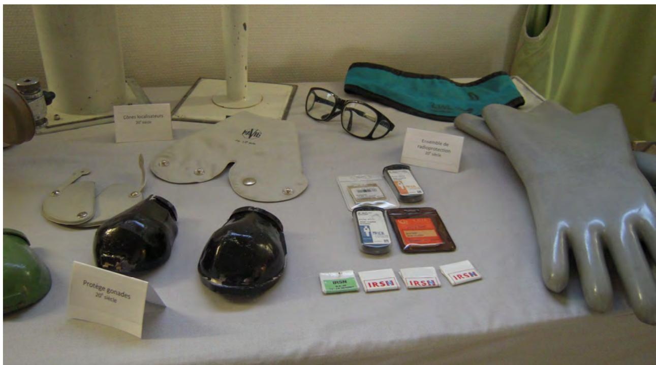
**Ensemble d'accessoires de radio-protection : cônes localisateurs, protège-thyroïde, lunettes et gants plombés, protège-gonades et dosimètres (coll. CPHR)**
