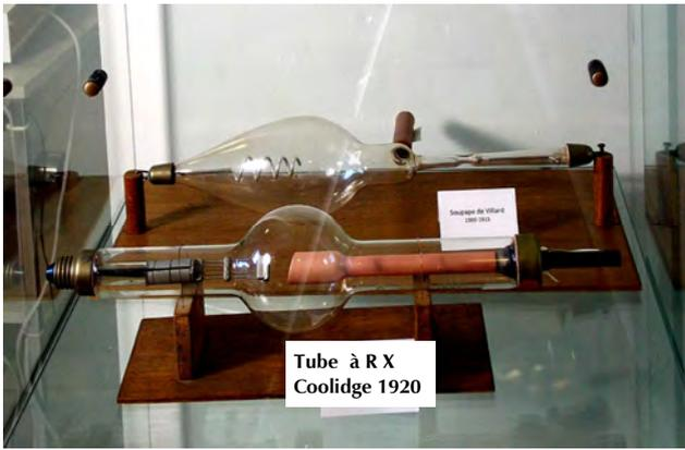
**Tube de Coolidge à anode fixe (1920)**
