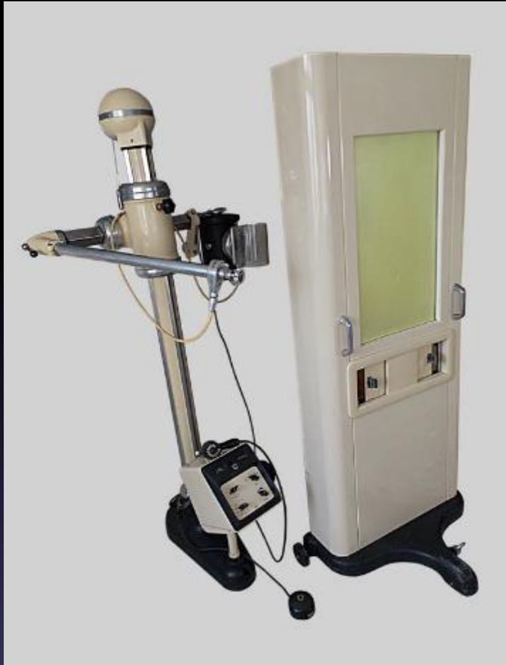
Appareil de radioscopie
