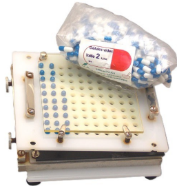
Gélulier semi-automatique Gélulier semi-industriel Seconde moitié XX e siècle. Coll. CPHR
